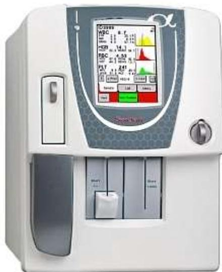
Счетчик гематологический Swelab Alfa серии Cap Piercer измеряет 20 параметров с дифференциацией лейкоцитов на 3 популяции и построением 3-х гистограмм. В отличие от “Swelab Alfa Basic” эта модель имеет устройство автоматического прокола колпачка пробирки и уникальный адаптер MCI для работы с “end-to-end” капиллярами. Данное дополнение позволяет защитить оператора от контакта с кровью пациента.
