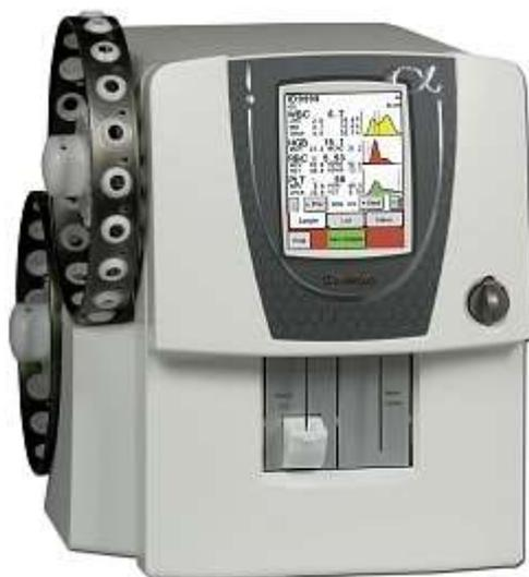
Счетчик гематологический Swelab Alfa серии Auto Sampler исследует 20 параметров с дифференциацией лейкоцитов на три популяции и построением трех гистограмм. Эта модель имеет устройство автоматической подачи пробирок - два барабана по 20 пробирок в каждом, и уникальный адаптер MCI для работы с end-to-end капиллярами.
