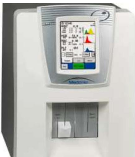
Гематологический анализатор Medonic M20 определяет 20 параметров крови с дифференцировкой лейкоцитов на 3 субпопуляции. Пропускная способность 67 тестов/час.
