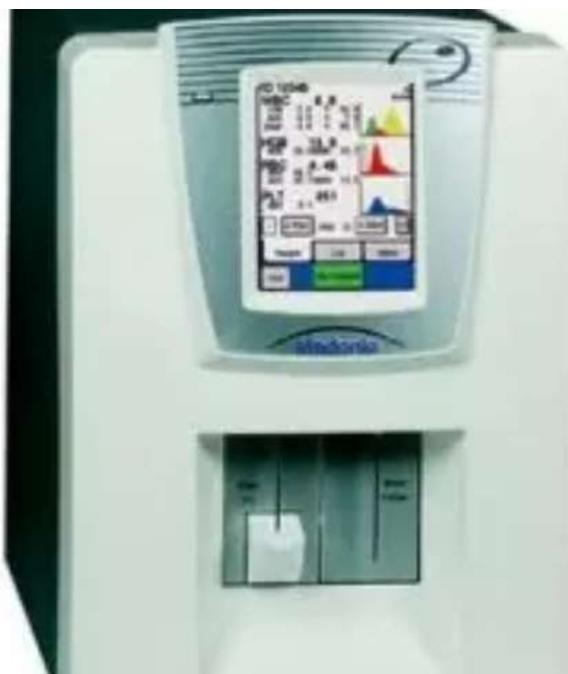
Компактный гематологический анализатор Boule MEDONIC M16 имеет встроенную память на 1000 результатов исследований и производительность 67 исследований в час.
